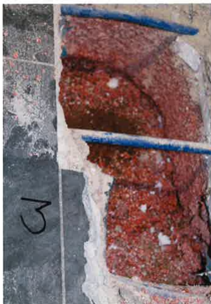
Abbildung 3: Beispiele Probenahme: Schüttung unter Estrich (unten), Gipskartonplatten (rechts oben), stehendes Wasser aus Elektroverrohrungen (rechts unten).
